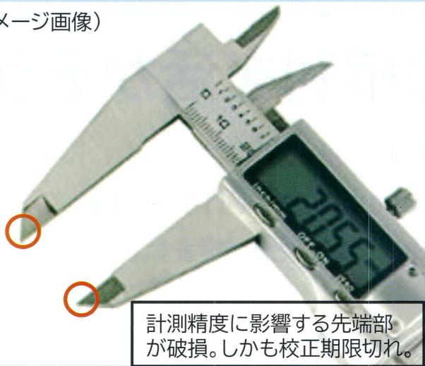
計測精度に影響する先端部が破損。しかも校正期限切れ。
